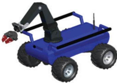
Robot "SADEWA" adalah robot yang berfungsi untuk memudahkan para pekerja pengukur jalan untuk mengukur jalan sebelum jalan itu dibangun. robot ini dilengkapi sistem android yang bisa dipantau dimanapun berada
