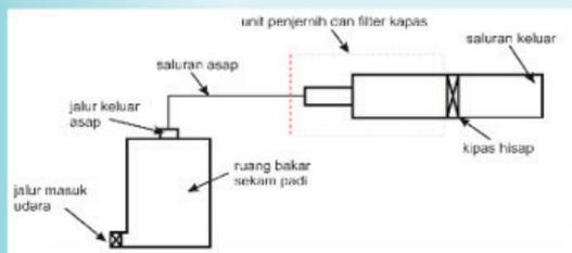
GAMBAR 1. Skema pengujian alat penjernih kabut asap
