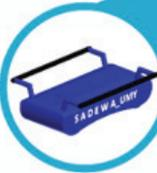
bodi berfungsi sebagai pelindung atau pengaman komponen elektronik dalam robot bodi pada robot "SADEWA" terbuat dari karton yang di desain sedemikian rupa agar ringan dan fleksibel
